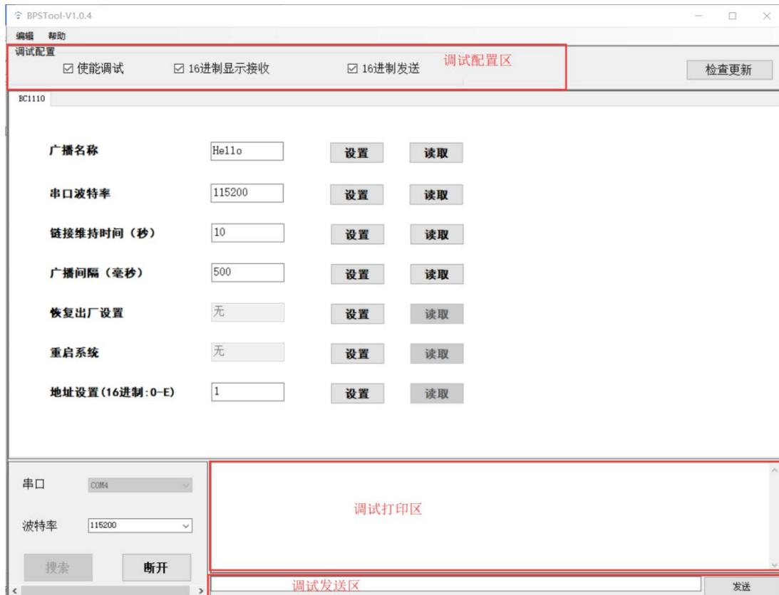
如图所示，当调试使能按钮“调试使能”勾选上时，调试打印区会显示发送和接收的数据。通过勾选“Hex 显示接收”和“Hex 发送”可以切换 16 进制方式显示或者发送。用户也可以在调试发送区编辑自定义数据，然后点击“发送”按钮向串口发送数据。
