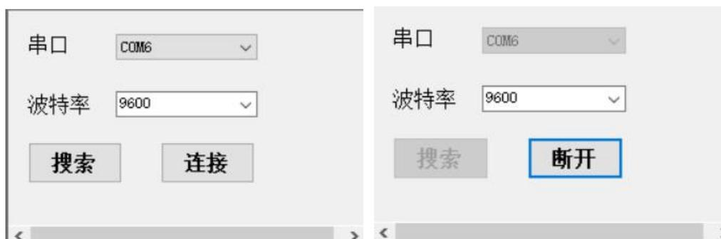
将 BPS 设备通过 USB 转 TTL 模块连接至电脑，如上图所示配置好串口和波特率即可开始连接，连接成功后，“连接”按钮显示为“断开”。
